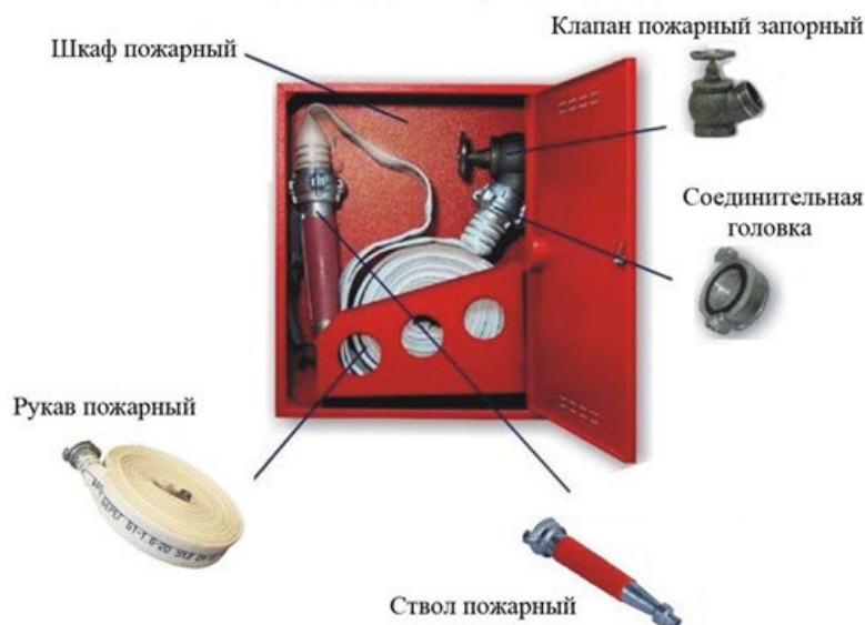
Рис. 2 Устройство пожарного крана
